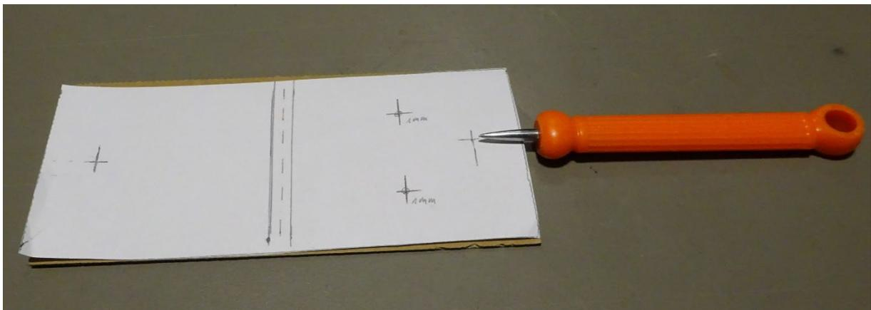
Bild 2: Schablone auflegen und Punkte markieren
