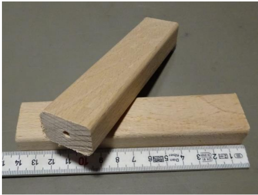
Abgelängtes Kant- oder Rundholz mit 3 mm Bohrungen an beiden Enden
